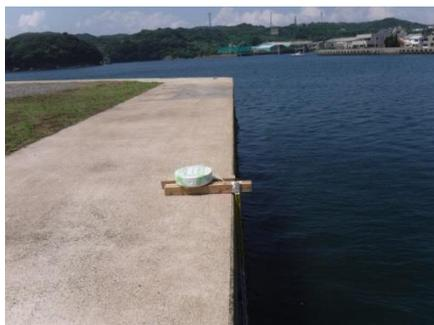
図 14 水位計の設置状況
