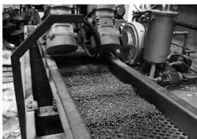
⑧原料のプラフは加熱溶融された後、カットされ「PE・PP混合ペレット」として商品化されます。
