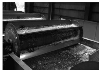
⑥粉砕されたプラスチック片は2回洗浄された後、比重分離槽に搬送されます。ここでは水に浮くポリエチレン、ポリプロピレンが回収され、厳密な選別が行われます。
