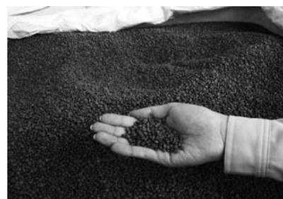
⑨再生処理された「PE・PP混合ペレット」は原材料として引き取られ、ハンガーや園芸用品などに加工され市場に流通します。
