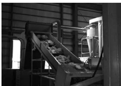
⑤選別されたプラスチックは、原料搬送コンベアにて「破砕機」に投入され、回転刃によって30mmに粉砕されます。
