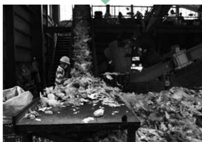
④保管所より運び込んだ梱包物は選別しやすいようにほぐされます。その後、手選別コンベアでリサイクル可能なプラスチック（レジ袋、包装材、ボトル等）が抜き出されます。
