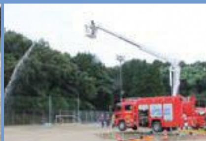
▲⑪13mのブームが付いた多目的消防ポンプ車で、上方から放水する消火活動
