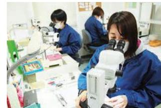
▲ひとつひとつ顕微鏡で製品の検査を行います
