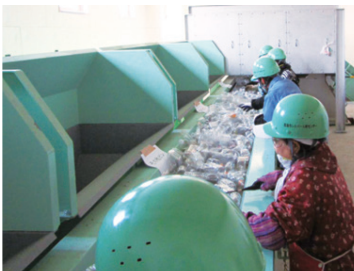
西海市リサイクルセンター 資源物選別作業
